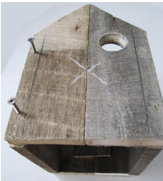
Placer les faces sur les côtés, percer un avant-trou et visser. Retourner l'ensemble. Percer un avant-trou et visser.
