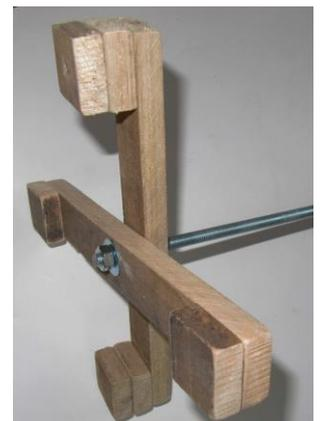
**3-** Faire un avant-trou de 2 mm. Visser les carrés aux extrémités des lames. Enfiler 1 rondelle et 1 écrou sur la tige filetée puis enfiler les lames du pied en commençant par la plus basse.
