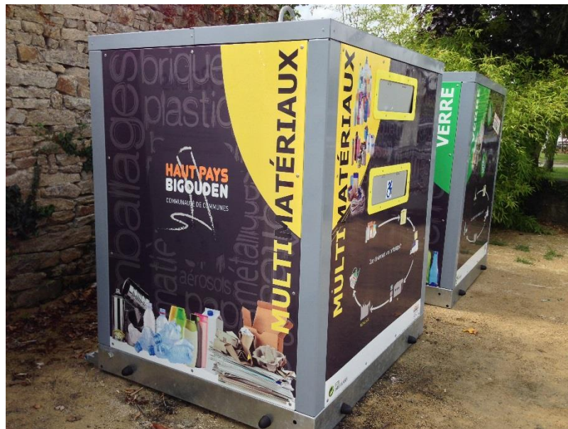
Colonnes de tri munies d'une trappe en partie basse pour faciliter le geste de tri aux personnes à mobilité réduite
