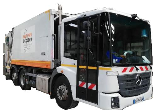
*Véhicules de collecte des déchets (V.C.D) de 12 tonnes de charge utile*
